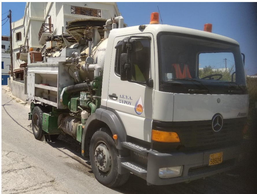
Εικόνα 7-1: Μηχάνημα έργου παραλαβής λυμάτων – ΔΕΥΑ Σύρου
